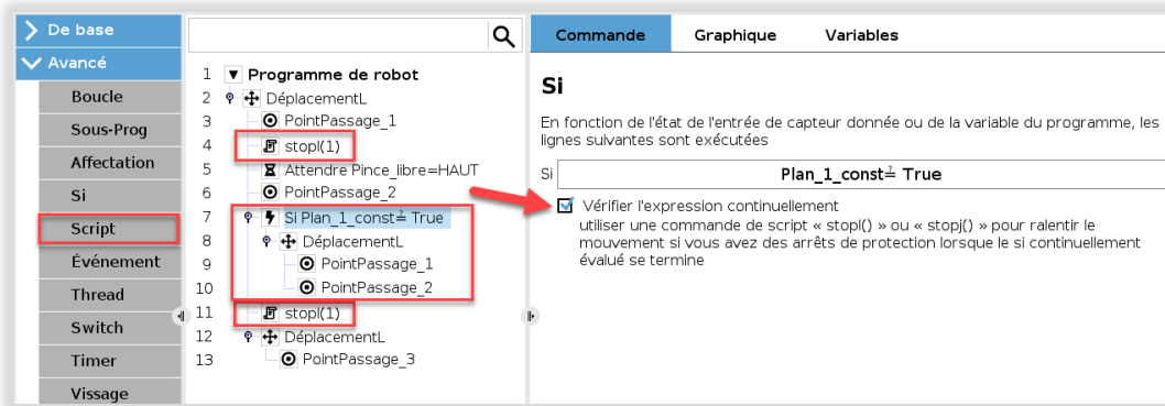
Exemple d'utilisation d'un script de commande stopl() et stopj()
